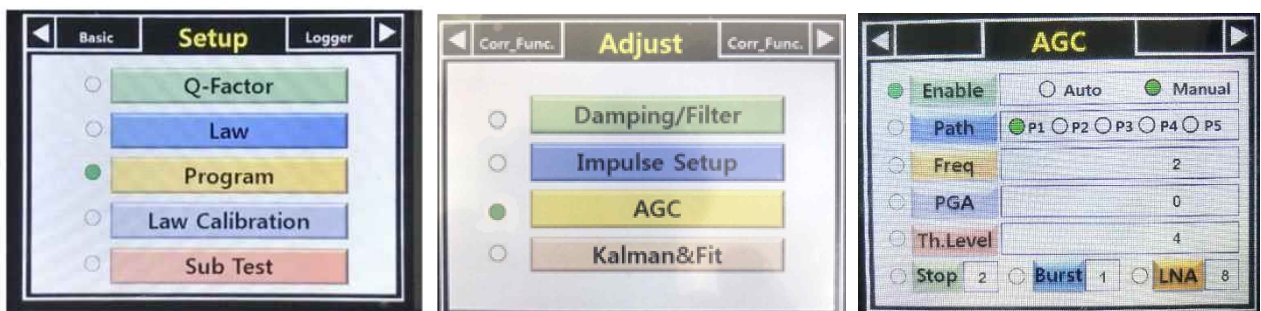
Figure 33 : 초음파 변환기의 수신 파형 증폭도 조정을 위한 AGC 메뉴
