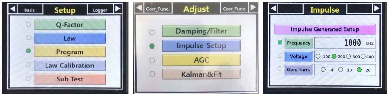
Figure 32 : 초음파 변환기의 발사주파수, 전압크기, 횟수를 조정하기 위한 Impulse 메뉴
