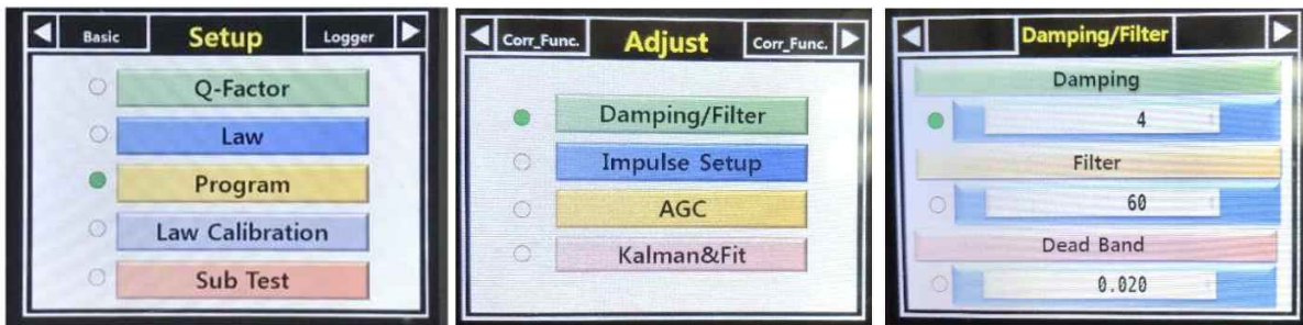
Figure 31 : Moving Average 시간 조절을 위한 Damping/Filter 메뉴
