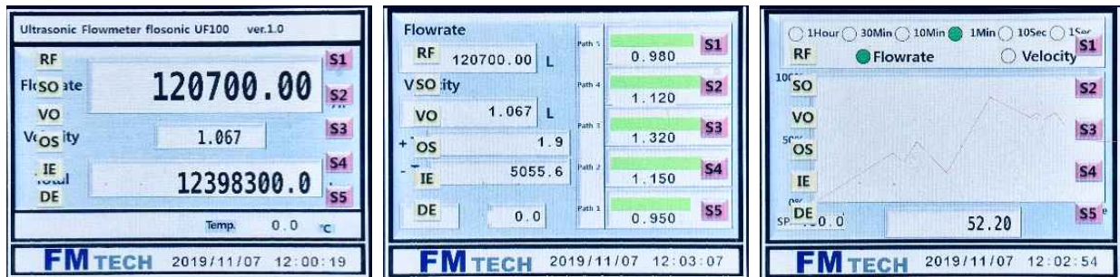
Figure 52 : 각종 Error 표시 위치 및 화면 구성
