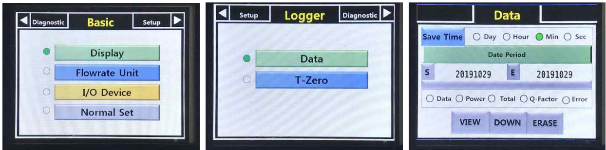
Figure 43 : 유량계 이력저장 및 내려받기를 위한 Data 메뉴 진입
