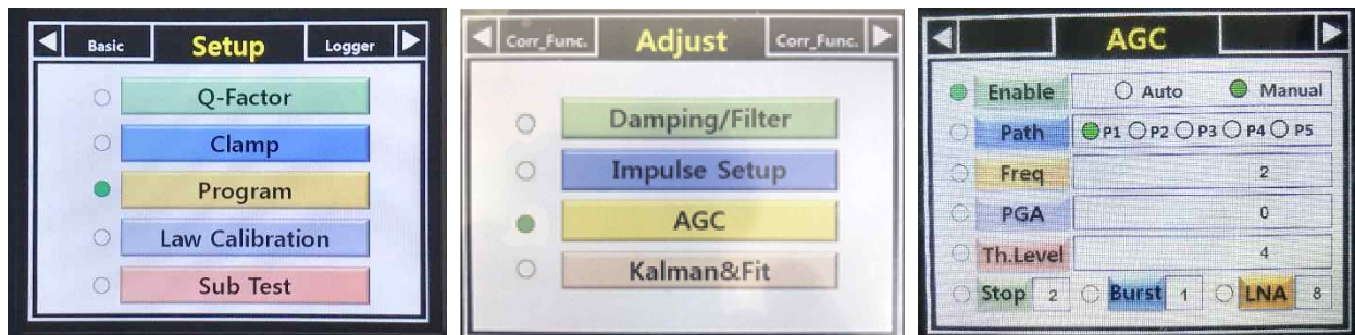
Figure 34 : 초음파 변환기의 수신 파형 증폭도 조정을 위한 AGC 메뉴
