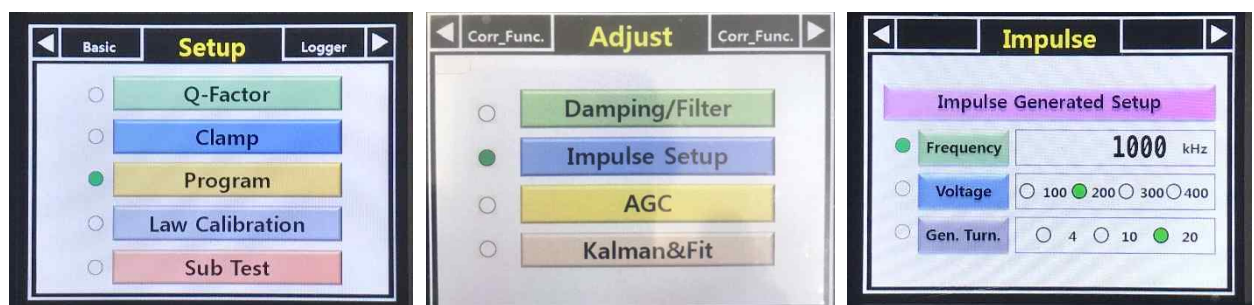
Figure 33 : 초음파 변환기의 발사주파수, 전압크기, 횟수를 조정하기 위한 Impulse 메뉴
