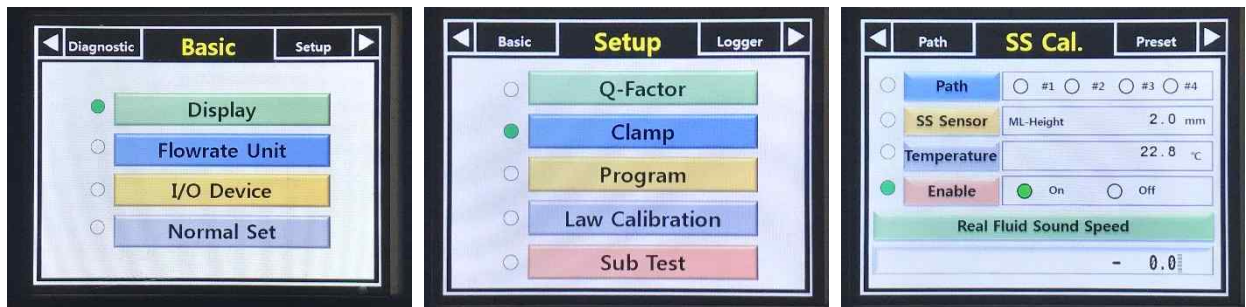
Figure 31 : 유체의 음속을 측정하기 위한 SS Cal. 메뉴
