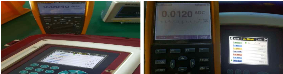
Figure 18 : 멀티미터를 이용한 4~20mA Calibration
