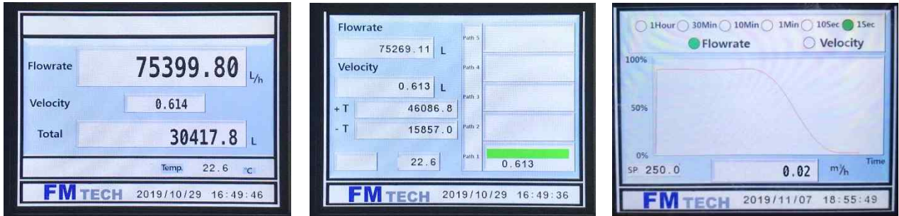
Figure 7 : Standard, Profile, Trend 모드
