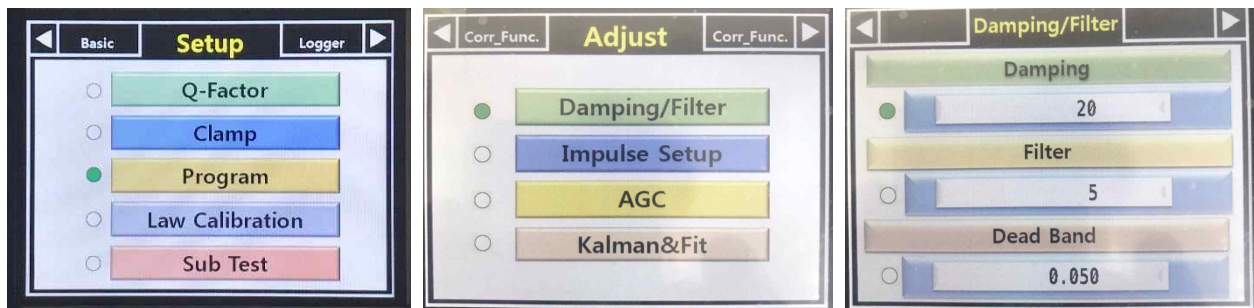
Figure 32 : Moving Average 시간 조절을 위한 Damping 메뉴
